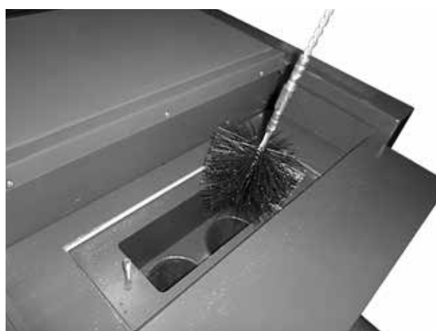
Тщательная чистка теплообменника (трубчатой доски) щеткой
