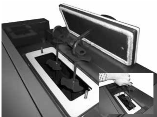
Выдвижение замедлителей из теплообменника (трубчатой доски) перед тщательной чисткой
