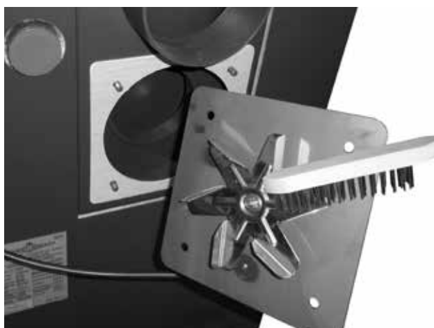
Чистка рабочего колеса и контроль лопаток вытяжного вентилятора (кроме D10PX)
